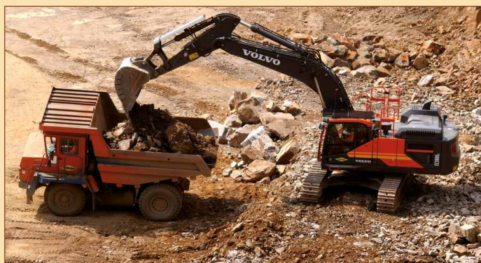
Nakládání bagrem a odvoz na drtič 2. etáž 2018
